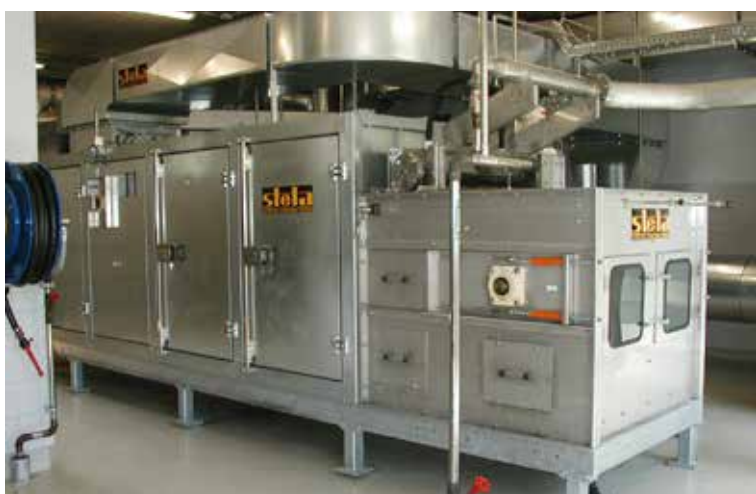
Projekt: Oberes Wipptal Ausztria Típus: PBTK 1/1000-5 Termék: szennyvíziszap Vízlevonási kapacitás: 100 kg/h
