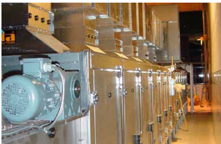
Projekt: ARA Sölden Ausztria Típus: PBT 1/2500-13 Termék: szennyvíziszap Vízlevonási kapacitás: 800 kg/h
