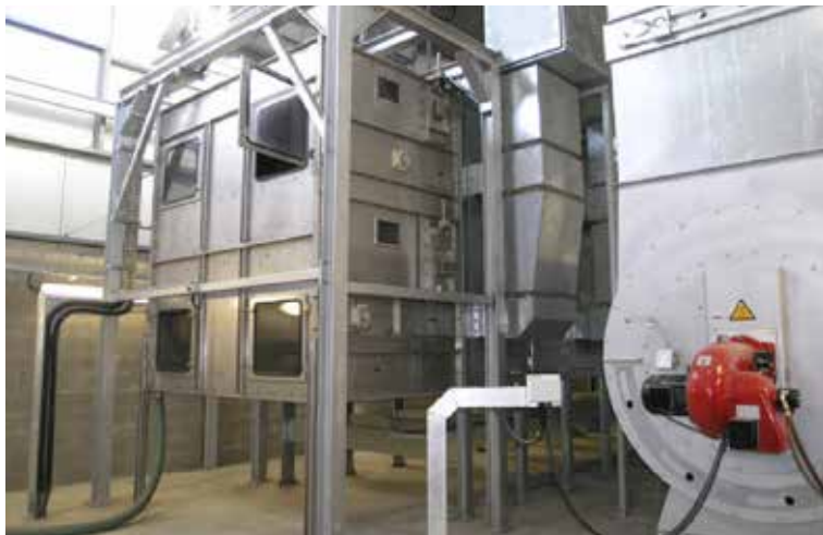
Projekt: Wexford Írország Típus: PBT 2/2500-12 Termék: szennyvíziszap Vízlevonási kapacitás: 1.250 kg/h
